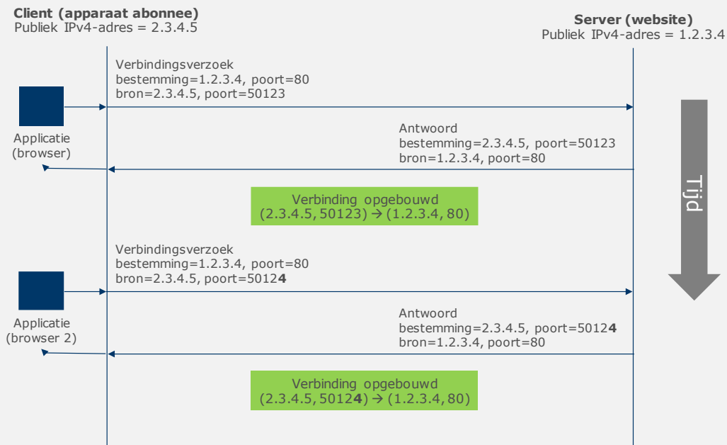
Figuur 14. Voorbeeld van verbindingsofbouw tussen een client en server op het internet (TCP/IPv4)
